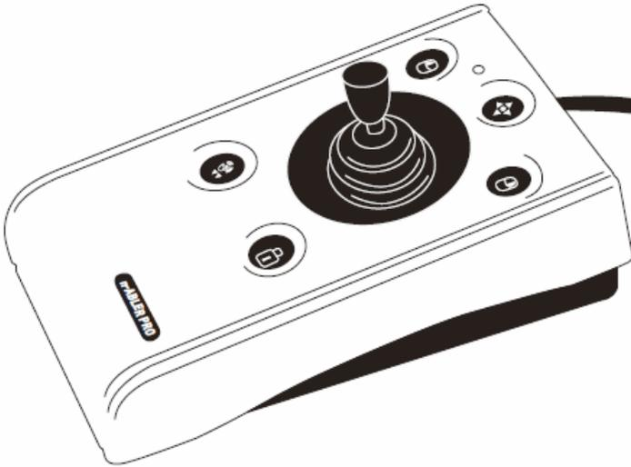
n-ABLER Pro Joystick は、手のコントロールに制限がある、運動技能の問題、手と目の協調が不十分、手先の器用さが限られている、不随意の筋肉のけいれん、手や手首の振戦がある、といったコンピュータユーザー向けに設計されています。最小限の動きで操作できるため、手首と肘の疲労を軽減します。左右対称な設計により、ユーザーは手首を傾けずに両手で作業できます。「左利き」操作用に構成することもできます。
