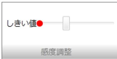
赤い丸が認識部位の動きに連動して、右方向に移動します。赤い丸が、しきい値(スライドバーのつまみの部分)を超えるとスイッチが ON になります。スライドバーのつまみをマウスでドラッグして、しきい値を調整します。
