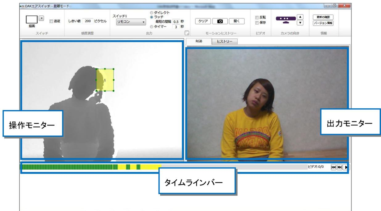
距離モードの時は、左側の操作モニターに距離センサーがとらえている画像が表示されます。キネクトに近い部分ほど黒く表示されます。エアスイッチの距離モードは、キネクトから 40cm から 150cm の距離にあるもののみ認識します。それ以外は白く表示されます。
