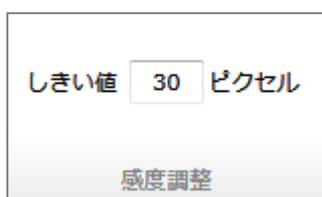
エアスイッチを設定した領域内で、どれだけの量の画素 (ピクセル) の色が変化すればスイッチを ON/OFF するのかの境界を、「しきい値」として指定できます。
