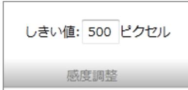
エアスイッチを設定した領域内にどれだけ体が進入すればスイッチを ON/OFF するのかの境界を、「しきい値」としてピクセル(画素)単位で設定できます。「しきい値」が小さいほど、感度が高くなります。
